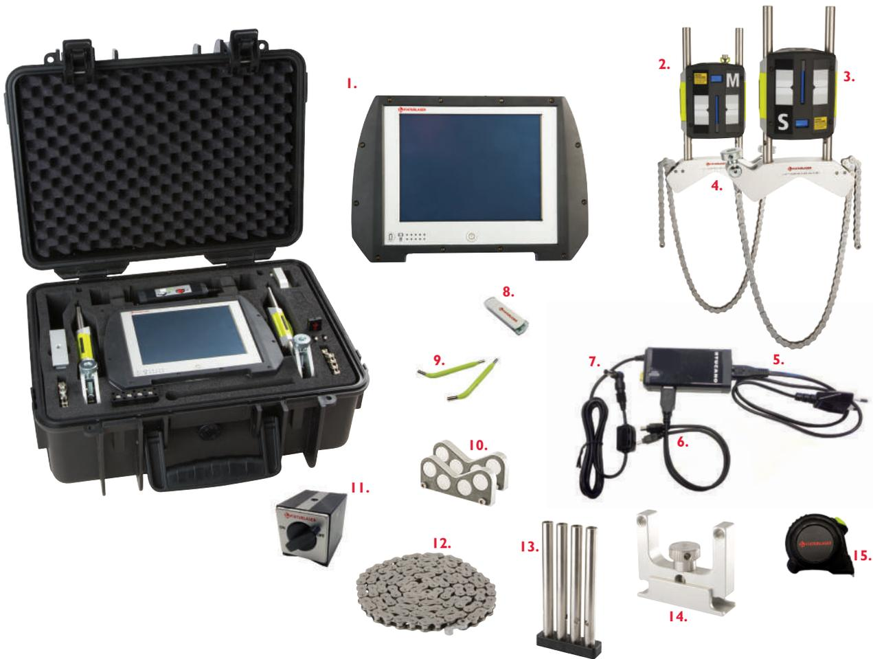
1. Unidad de pantalla 2. Fixturlaser M3 3. Fixturlaser S3 4. 2 piezas completas Soporte en V 5. Cable de alimentación ext. 6. Cable USB A-mini 7. Fuente de alimentación 8. Tarjeta USB 9. Herramienta universal angulada, 2 unidades 10. Soporte en V magnético, 2 unidades 11. Base magnética 12. Cadena de 8 mm, 60 eslabones L=970 mm 13. Kit de varillas 14. Dispositivo de extensión 15. Cinta métrica, 5 m
