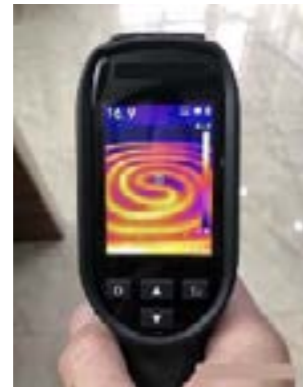
Verificar la Calefacción
