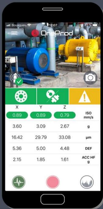
El Bearing Defender solo tarda 10 segundos en capturar, procesar y mostrar los datos resultantes de la medición en las tres direcciones X, Y , Z.
