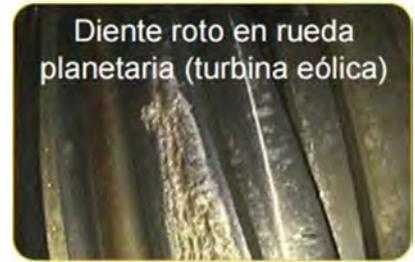
Diente roto en rueda planetaria (turbina eólica)
