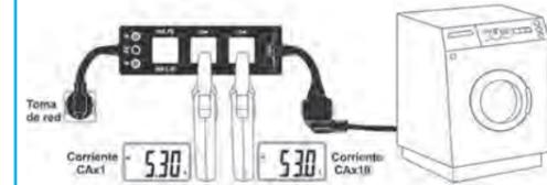
LINESPLITTER dispone de 2 anillos (A x 1 y A x 10 – ver figura superior) para realizar respectivamente la medida de la corriente real de línea y la medida de la misma corriente multiplicada por 10 (de utilidad en caso de uso de pinzas amperimétricas con sensibilidad escasa o con escalas de medida demasiado altas).
