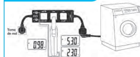
LINESPLITTER permite también la realización de medidas de tensión L-N, L-PE o N-PE e Intensidad a la vez (vea la figura superior) por lo que si utilizamos una pinza Vatimétrica podremos además de ver la tensión e intensidad, el consumo generado por el receptor en examen.
