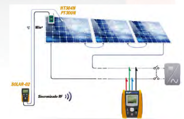
Medida de una curva I-V con sincronización a distancia de irradiación y temperatura
