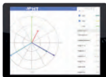
Ejemplo de visualización Asimetrías en tiempo real
