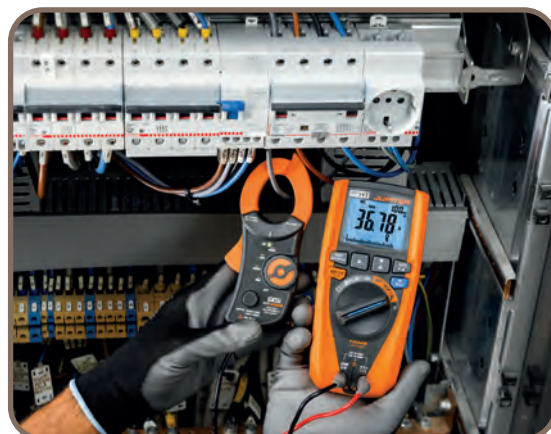
Medida de intensidad a través del transductor de corriente HT4006 (opcional)
