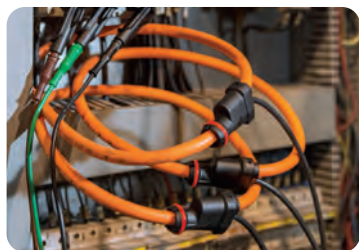
4 maxilares flexibles para la medida de corriente incluyendo la intensidad de neutro
