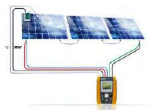
Medida de una curva I-V con sensores ambientales conectados al I-V500w
